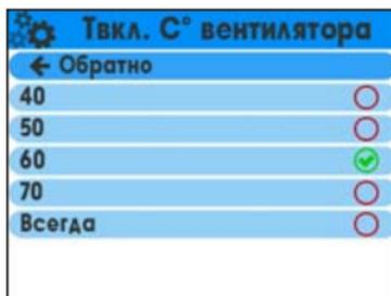
Вентилятор включится при достижении установленной температуры внутри устройства и выключится при остывании. При выборе «Всегда» вентилятор будет работать постоянно.
