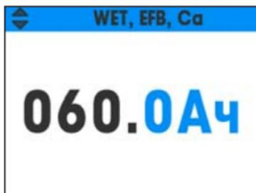
«Ручная настройка» зависит от настроек «Шаблон АКБ», при изменении настроек заряда методом выбора другого шаблона АКБ, настройки в разделе «Ручная настройка» также изменятся. Для удобства детальной настройки рекомендуется сначала выбрать параметры из библиотеки «Шаблон АКБ», а затем вносить изменения в разделе «Ручная настройка».
