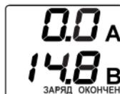
Электронная схема ЗУ контролирует напряжение и ток в процессе заряда. Если напряжение на зажимах ЗУ стабилизировалось, а ток не превышает 10% от установленного в начале заряда значения, то ЗУ считает такую АКБ заряженной. На экран будет выведено сообщение «**ЗАРЯД ОКОНЧЕН**».
