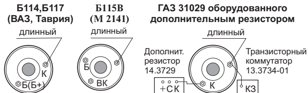
Рис. 2 - Подключение к карбюраторному двигателю
