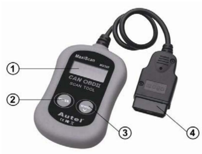
1. **Жидкокристаллический дисплей** - отображает результаты проверок. Двухуровневый дисплей 8 символов в каждой строке.
