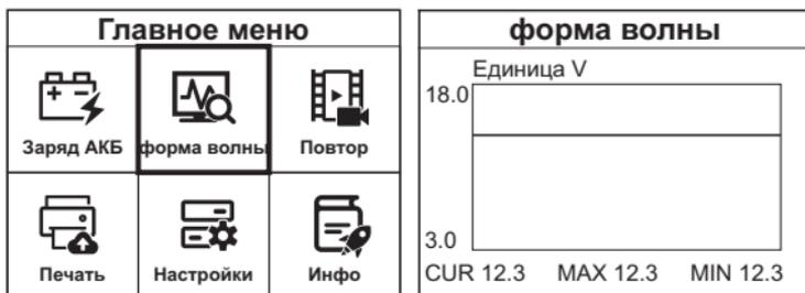
На экране будет отображен график напряжения, а также значения действующего (CUR), минимального (MIN) и максимального (MAX) напряжения.
