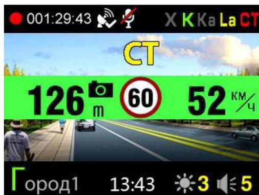
SHO-ME Combo №5 A7 сравнивает скорость автомобиля с разрешенной на участке скоростью. И если скорость автомобиля выше, голосовое оповещение сообщает об этом, а на дисплее зеленая полоса становится красной.
