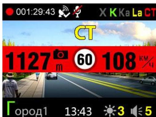
Особый тип камер – контроль средней скорости (КСС), к ним относится система Автодория. Эта система измеряет среднюю скорость движения автомобиля между двумя точками с установленными камерами. Для правильного оповещения пользователя Combo №5 A7 считает среднюю скорость после проезда первого модуля КСС и сравнивает ее с лимитом на участке
