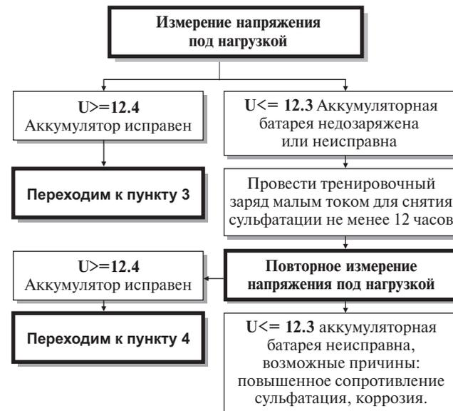
**Пункт 4.** Проверка аккумуляторной батареи Электронной нагрузочной вилкой, в качестве нагрузки используется стартер. (Батарею заряжали в пунктах 2 или 3.)
