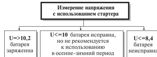
\*\* Для корректного измерения параметров необходимо производить измерения не ранее чем через 30 минут после выключения двигателя.
