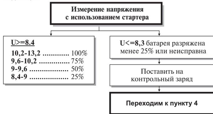
**Пункт 2.** Проверка аккумуляторной батареи слаботочной нагрузкой.
