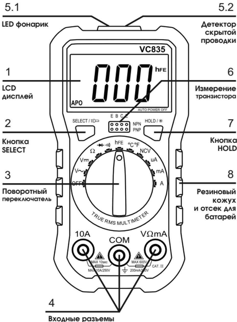
1. **LCD дисплей.** Отображает измеряемое значение и значок величины измерения.
